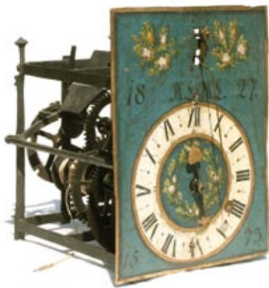
Abb. 4: Kleine gotische Hausuhr, Süddeutschland, bez. und datiert 18 ALML 17 und 1573. Hausubren sind kleine Turmuhren, die in großen Sälen auf Konsolen an der Wand standen und über Zugseil mit Glockenhammer auf eine darüber liegende Glocke schlugen. 1827 erfolgte der Umbau auf ein genaueres Hemmungssystem.
