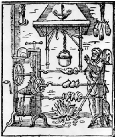
Abb. 11: Mannshober Bratenwender. Titelblatt zu „Il Trincante“ von Vincenzo Cervio, Venedig 1622. Nachdruck eines Holzschnittes von 1570 (Willan). Selten exakte Darstellung eines Federbratenwenders.
