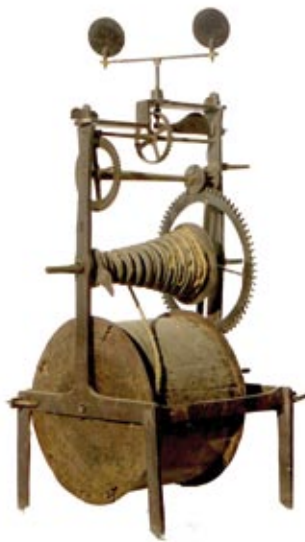
Abb. 6: Federbratenwender, frühbarock, Ende 17. Jahrhundert, Stuben bei Bernstein. Dieser Bratenwender dürfte ursprünglich im Meierhof unterhalb der Burg gestanden sein.
